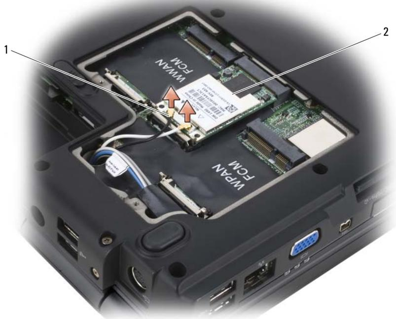
1 Conectores del cable de antena (2) 2 Tarjeta WLAN
