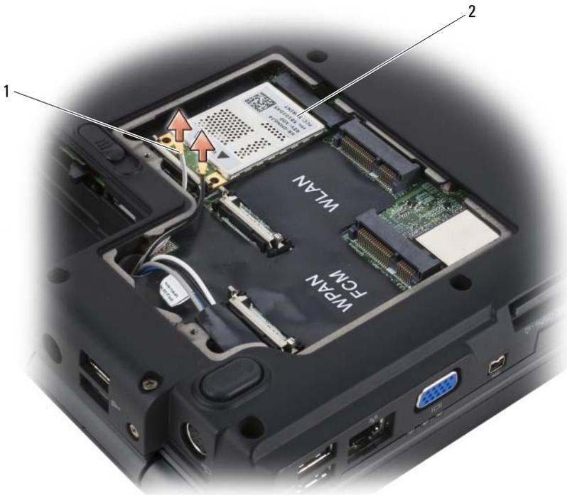
1 Conectores del cable de antena (2) 2 Tarjeta WWAN
