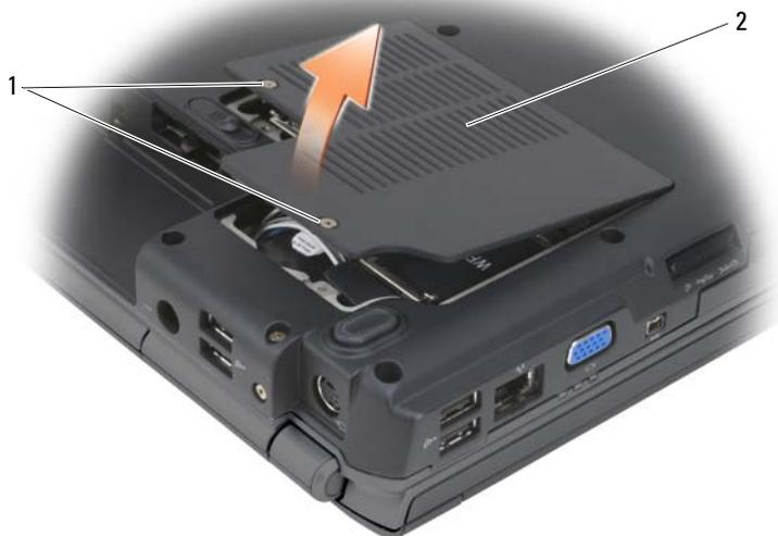
1 Tornillos de sujeción (2) 2 Cubierta de la minitarjeta
